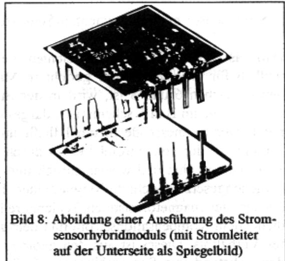
**Bild 8:** Abbildung einer Ausführung des Stromsensorhybridmoduls (mit Stromleiter auf der Unterseite als Spiegelbild)
